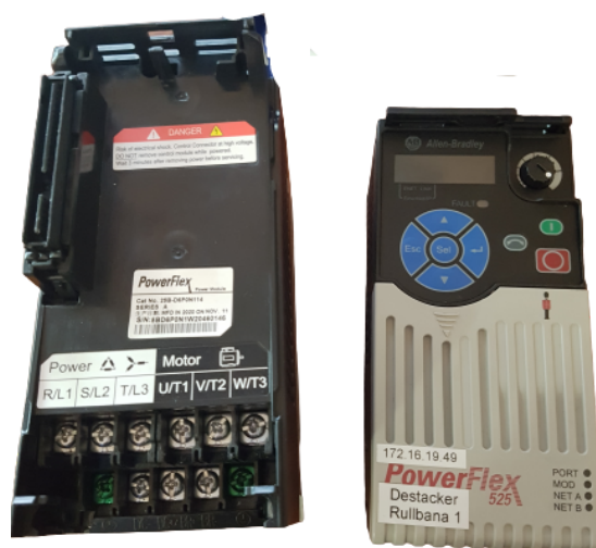
Figur 5.3: PowerFlex 525 moduler (kraftmodul (vänster) och logikmodul (höger))
