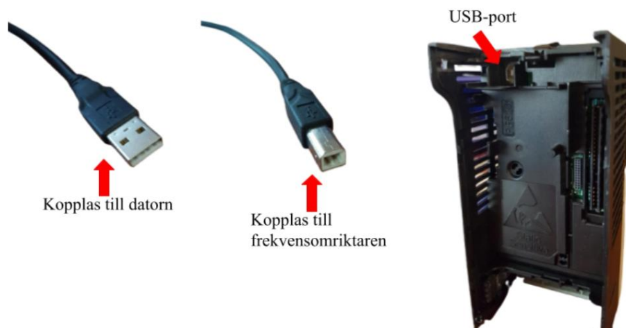
Figur 15: Hur PowerFlex 525 kopplas till datorn
